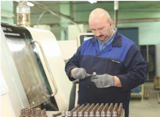
Для изготовления резцов используются специальные марки твердых сплавов, которые производятся из крупнозернистых сортов карбида вольфрама, которые по твердости уступают только алмазу. Такие сплавы имеют высокую прочность, и обладают повышенной абразивной стойкостью и стойкостью к воздействию циклических ударных нагрузок.
