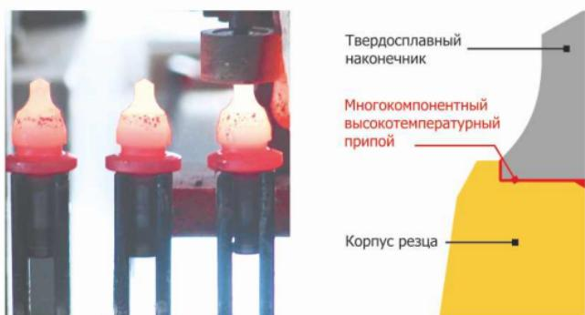
Качество пайки гарантируется. Специальный метод контроля позволяет определить уровень усилий, возникающих в паяном соединении при сдвиге наконечника относительно корпуса резца. Наконечники выдерживают при испытаниях огромные усилия сдвига: резец A6/20 от 4500 кгс и более, резец A8/20 - от 9000 кгс и более.
